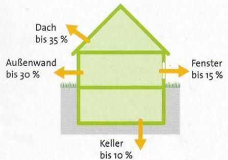
*Über Dach, Fenster, Außenwände und Keller entweicht Energie.*
